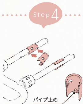
Step 4 高さ調整ができます 設定する高さに パイプ止めを取り付ける
