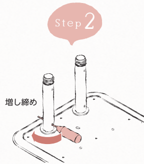
Step 2 増し締め ドライバーや棒を差し込み 増し締めする
